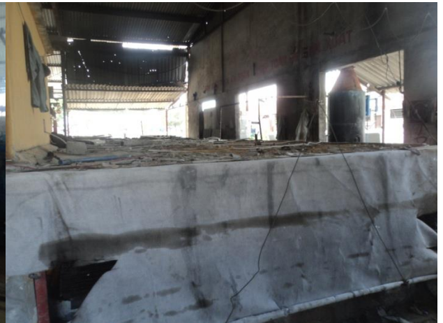
Hình 18. Hầm dưỡng hộ tấm (ủ) gia nhiệt bằng điện của Công ty Vân Long - Đà Nẵng
