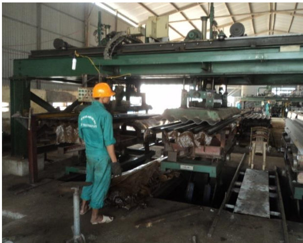
Hình 19. Máy dỡ tấm ở Công ty Hà Thái- Thái Bình
